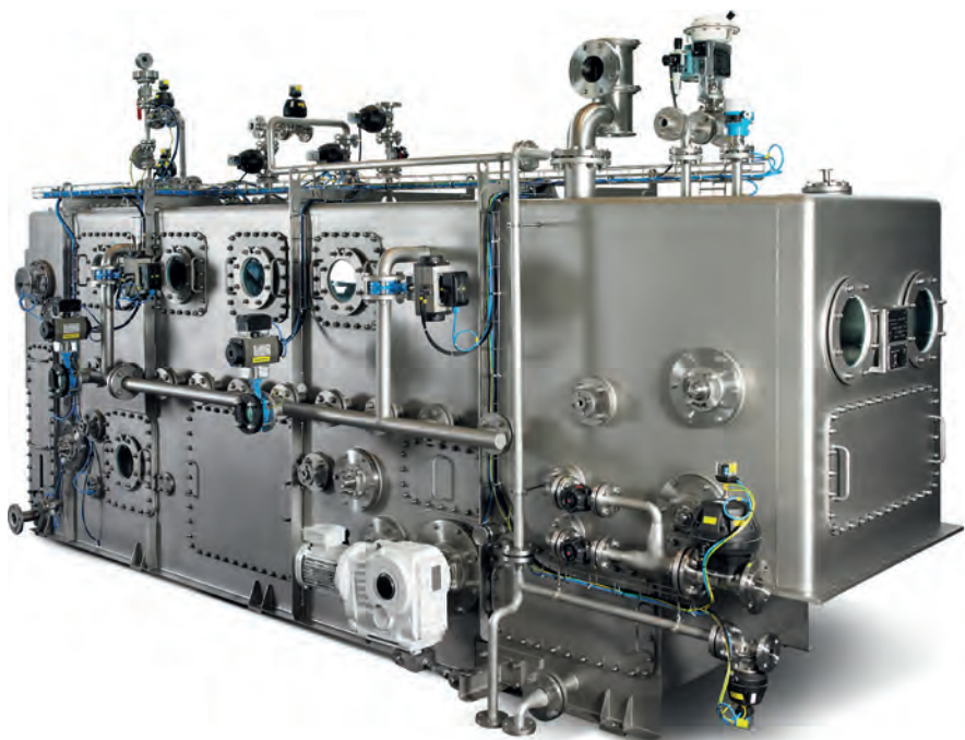
Afb. 2 De BHS roterende filterpers is een continu vacuümfilter om vaste stof te wassen en droog af te scheiden
