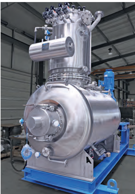
Afb. 1 In een en dezelfde reactor worden achtereenvolgens diverse processtappen uitgevoerd
