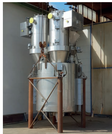
Afb. 3 Een AVA verticale droger met elektrisch verwarmde mantel, voor pyrolyse-toepassingen bij een temperatuur tot 600°C
