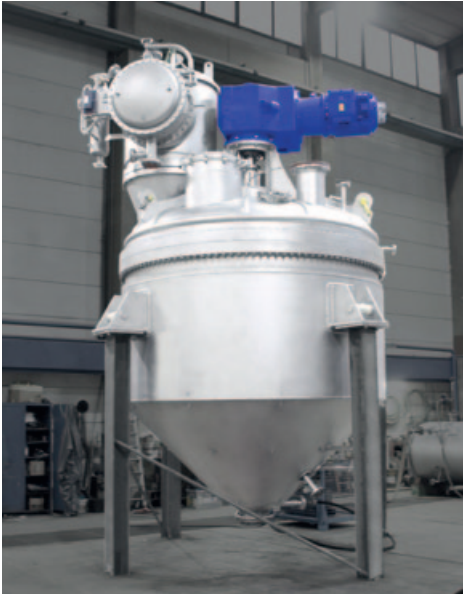
Afb. 3 Verticale droger (a) met werkingsprincipe (b)
