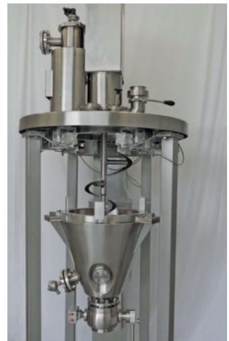
Afb. 4 De hefkolom maakt een complete en snelle reiniging van de verticale droger mogelijk
